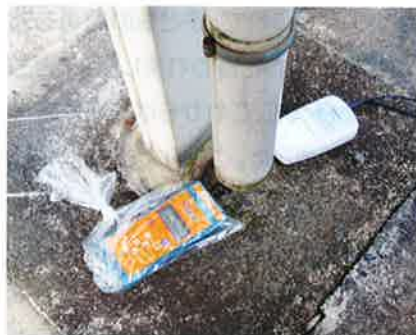
●図10 雨樋の下、ホットスポット ( 4\mu\text{Sv/h} )
