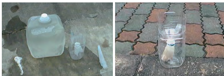
河川水からのウイルス回収(イオン交換樹脂吸着法)
